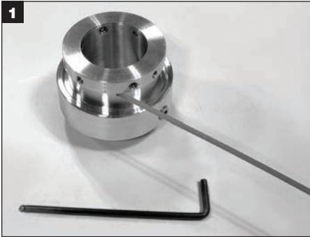
シールの分解に必要な工具：六角ねじ回し（シールに付随）、ピンセットと先の曲がったつまみ道具（客先が準備、O-リングの除去用）。
