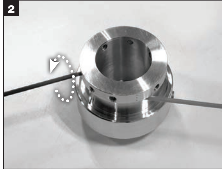
ロックリングからカップポイントスクリューと1/4ドッグセットスクリューをすべて外し、廃棄します。
