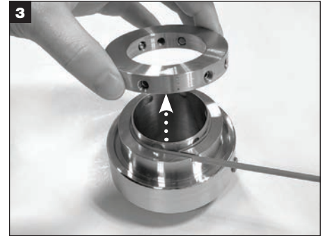
スリーブからロックリングを外し、脇に置きます。センターリングストラップを外します。
